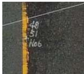
低解像度カメラで撮影した画像 (解析に使用不可能)
